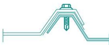
FIXATION RECOUVREMENT LATÉRAUX
