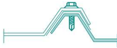
FIXATION RECOUVREMENT LATÉRAUX
