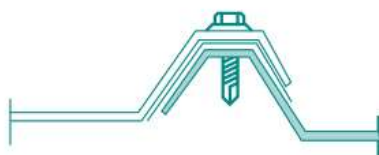
FIXATION RECOUVREMENT LATÉRAUX
